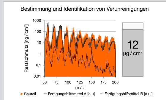
Das Diagramm zeigt den Vergleich von Signaturen eines verunreinigten Bauteils mit zwei Fertigungshilfsmitteln „FHM A“ und „FHM B“. Die übereinstimmenden Signaturen identifizieren FHM A als Verunreinigungsursache. Die vorhandene Restschmutzmenge beträgt 12 µg/cm<sup>2</sup>.
